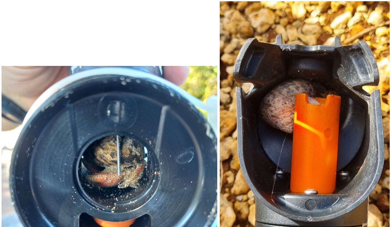
Photo 11 : Exemple de prise accessoire impliquant un bernard l'hermite, avec blocage ou non du piston, pouvant rendre le piège inopérant.
